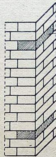
376. zīm. Ielikamo aplodu piestiprināšana.
